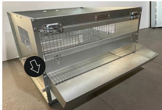
**6 этап:** яйцескат монтируется на винты, резьбовые заклепки уже установлены в боковых стенках.
