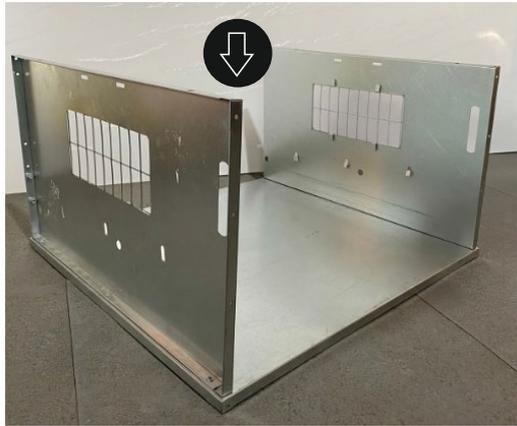
**3 этап:** устанавливается задняя стенка. Снаружи, через отверстия в боковых стенках, устанавливаются два продольных стержня, для поддержки сетчатого пола.
